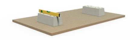
3. Stellen Sie die AROS Bank so auf die Betonsockel, dass die Löcher in der Sockelplatte mit den Schraubhülsen des Sockels übereinstimmen. Verwenden Sie ggf. einen Gabelstapler fur das Gewicht des Sofas.
